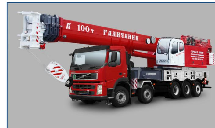
мой для работы в стесненных условиях. Прибор имеет встроенный блок телеметрической памяти («черный ящик») и модуль защиты крана от опасного напряжения (МЗОН) для работы вблизи линий электропередач
